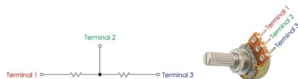
Figura 1.10: Potenciómetro y sus terminales. Fuente: (Mecafenix, 2020).
