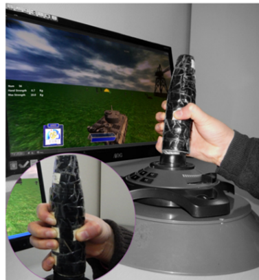
Figura 2.31: Ejecución de la rutina de trabajo con el uso de un joystick en forma de elipsoide. Fuente: (Xiao et al., 2018).
