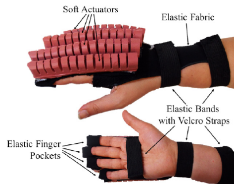
Figura 2.24: Vista superior y lateral con el uso del prototipo montado sobre la mano del usuario demostrando la sujeción con velcros del guante y los actuadores suaves. Fuente: (Polygerinos et al., 2013).
