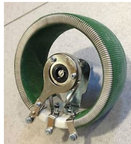
Figura 1.12: Potenciómetro del tipo bobinado. Fuente: (Mecafenix, 2020).
