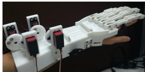
Figura 2.25: Prototipo del sistema de exoesqueleto para rehabilitación de la mano. Fuente: (Pu et al., 2014).
