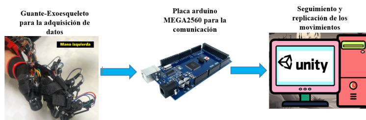
Figura 3.18: Diagrama a bloques para la conexión y comunicación entre el guante-exoesqueleto, la placa electrónica y Unity.
